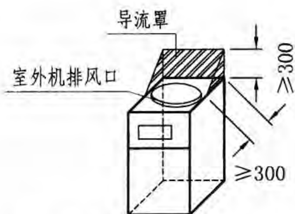
室外机安装导流风帽示意图
