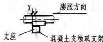
管道滑动支座安装示意
